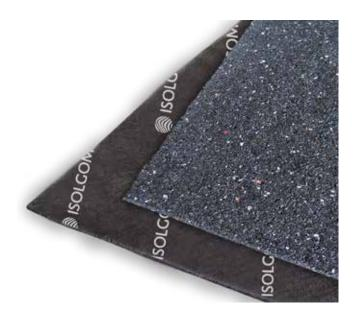
La ligne SYLPRO AD est une membrane de protection pour la construction, composée de granulés de caoutchouc SBR ancrés et pressés à chaud avec des liants polyuréthanes. Le matelas se prête aux applications les plus variées comme membrane protectrice et anti-abrasion. Sylpro AD est un produit drainant et résistant à la glace qui permet une stabilité des performances
