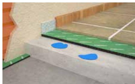
En cas d'humidité excessive, traiter la surface avec un primer
