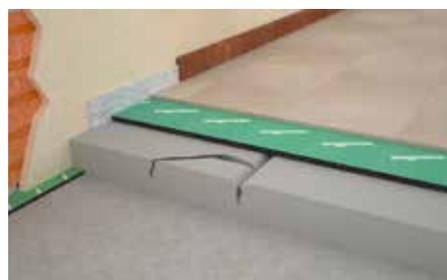
Les fissures doivent être réparées avec des produits appropriés, tels que des adhésifs ou des résines époxy spéciales.
