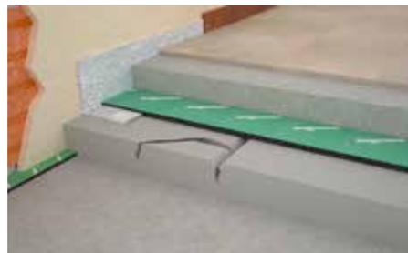
Les fissures doivent être réparées avec des produits appropriés, tels que l'adhésif époxy appropriés ou la résine.
