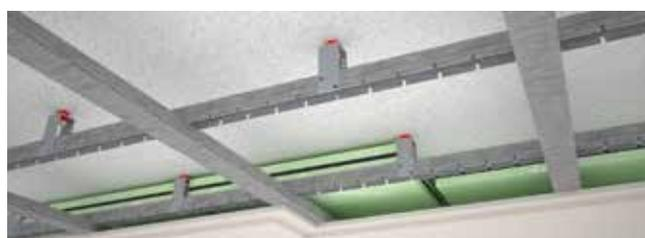
La connexion doit être faite exclusivement sur les éléments de structure du plancher avec ancrages en acier homologués comme Fischer FNA II, FBN II, FBS pour planchers traditionnels ou vis de structure pour planchers en bois. Fixer le cadre primaire sur les supports Redfix U à l'aide de vis pour cloison sèche à tête de plaquette.
